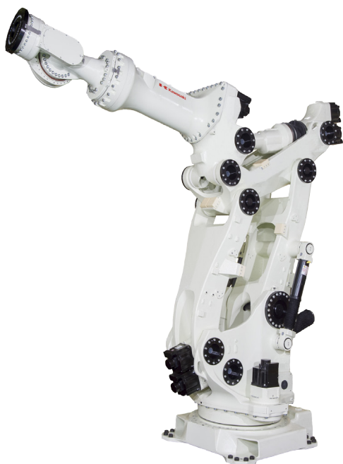
Robot MG10HL – nosnosť 1 000/1 500 kg, dosah 4 005 mm, opakovateľnosť \pm 0,1 mm
