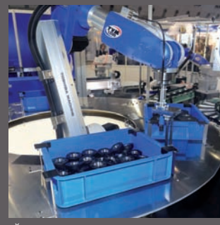
Šesťosový robot Toshiba Machine TVM v aplikácii Bin Picking využívajúci SW produkty TSAssist a TSVision3D – štandardné, cenovo dostupné riešenie
