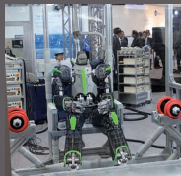
Humanoidný robot Kawasaki – v pozadí vidieť „vežu“ s 24 riadiacimi modulmi F60
