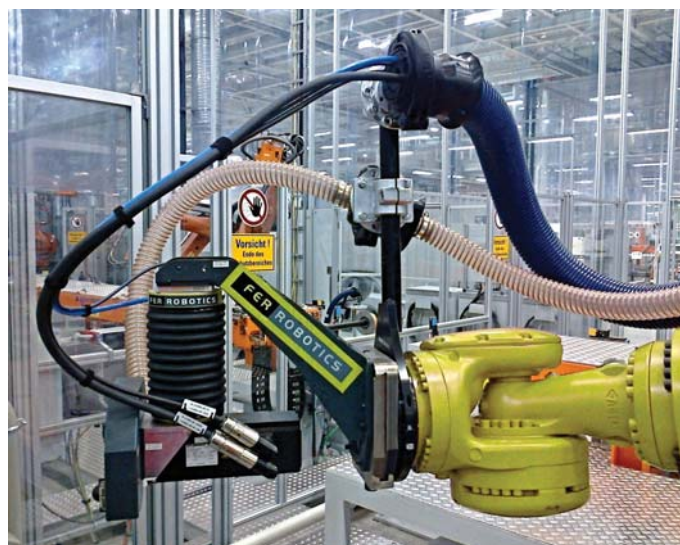
Robotická bunka pre brúsenie (s odsávaním) povrchov napr. zvarov.
