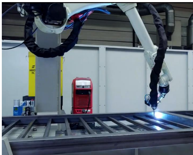
Zvary urobené robotom Kawasaki Robotics RA006L sú mimoriadne estetické a dokonale pripravené na ďalšie výrobné fázy.
