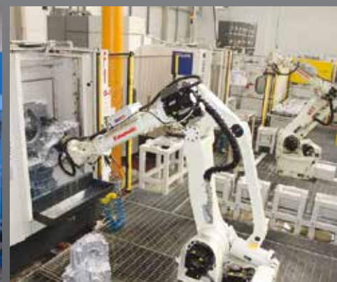
Ukážka nových robotov BXP110L - zváranie, KJ155 - striekanie vnútorných častí dverí a BU015X - nanášanie tmelu vo vnútri karosérie
