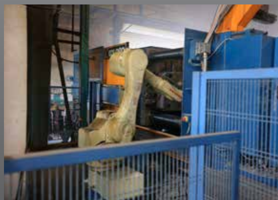
Vkladanie, vykladanie obrobkov do CNC strojov a vstrekolisov
