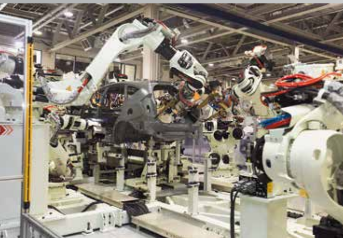
Ukážka technologickej hustoty BX robotov s rôznymi nástrojmi (FSJ aj klasické bodové spájanie)
