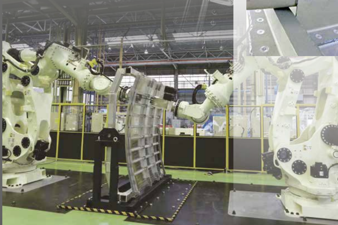
Príprava časti trupu Boeingu použitím RFSJ nástroja s dvomi robotmi MG15HL
