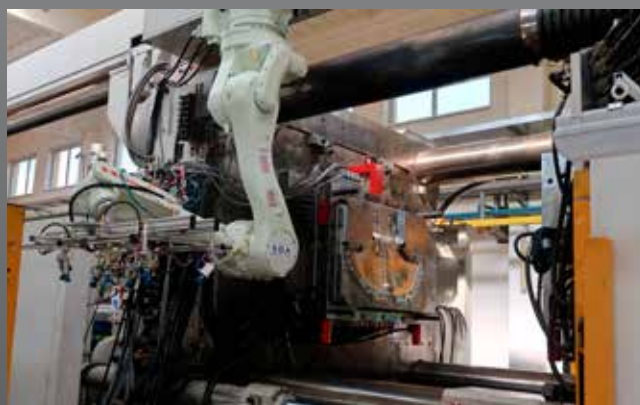
Vkladanie, vykladanie obrobkov do CNC strojov a vstrekolisov
