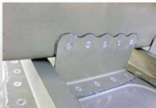
Príprava časti trupu Boeingu použitím RFSJ nástroja s dvomi robotmi MG15HL
