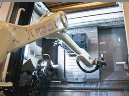
Vkladanie, vykladanie obrobkov do CNC strojov a vstrekolisov
