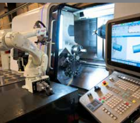
Vkladanie, vykladanie obrobkov do CNC strojov a vstrekolisov
